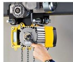
Удобный доступ к фрикционной муфте для регулировки
